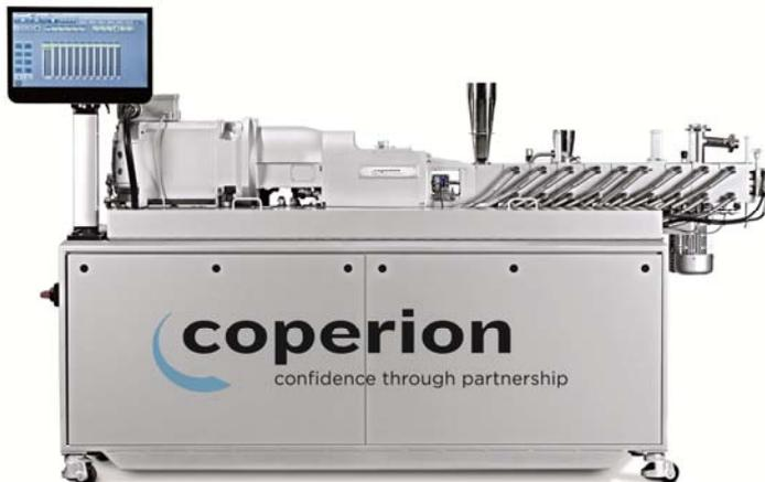
*Klar aufgebaut und gut zu reinigen – das sind die sichtbaren Merkmale des neuen Laborextruders ZSK 26 Mc<sup>18</sup>; zu seinen inneren Werten zählen das auf 15 Nm/cm<sup>3</sup> erhöhte Drehmoment und die noch schonendere Produktaufbereitung bei einem um bis zu 100 % höheren Durchsatz*
